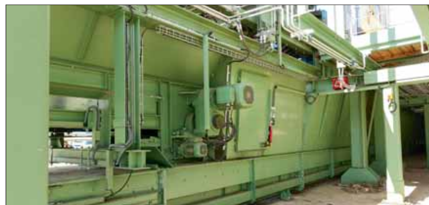
Blick auf die Verblechung zwischen der Rundholzförder- und Entsorgungstechnik am Übergang zwischen Rollenband – mit speziellen Abstreifelementen und motorisierter Reinigungsbürste – und Kettenförderer
