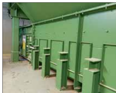
Verstärkung des Kappholz-Kettenförderers mit Stahlträgern und Schwingungsdämpfern
