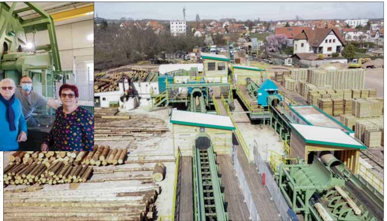
Der neu installierte Rundholzplatz bei Feidt in Molsheim: links die Linie für Langholz, rechts für Abschnitte. Auf dem Null-Niveau des Platzes unterhalb des hier sichtbaren Holzbodens sorgt die automatisierte Entsorgung von Rudnick und Enners nun für einen reibungslosen Betrieb und Sauberkeit. Fotos: BSR Engineering/Gebele
