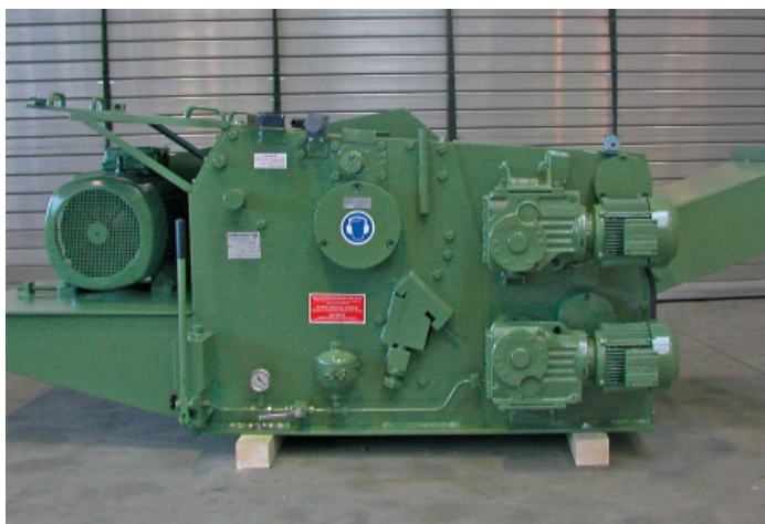
Hacker kurz vor der Auslieferung: um einen reibungslosen Betriebsablauf zu gewährleisten wurde ein Rudnick & Enners-Hacker installiert
