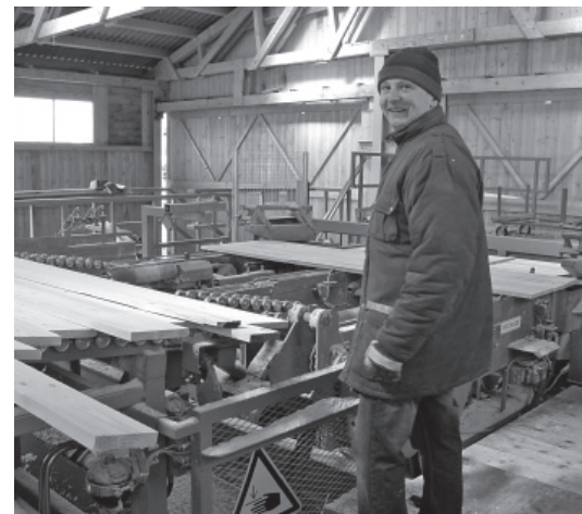
Neue Springer-Schnittholzsortierung bedient Mitarbeiter Walter Traxler
