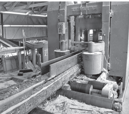
Bis zu 12 m-Stämme werden am Esterer-Gatter verarbeitet
