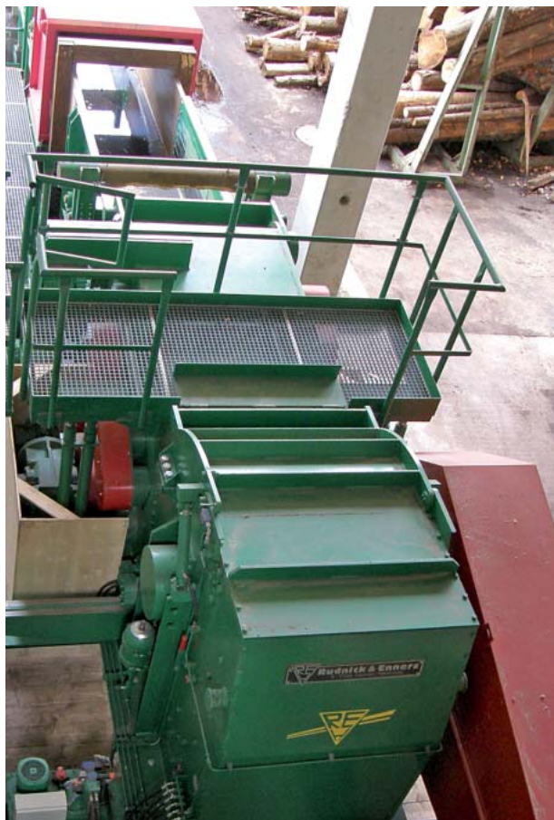
Blick von oben auf den Hacker – Durchmesser bis 815 können verarbeitet werden
