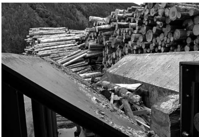
Aufgabe der Resthölzer, die neben der Hackstation zwischengelagert werden können
