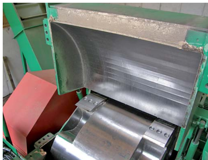
Die zwei Außenmesser im geöffneten Hacker – Messeranordnung sorgt für geringen Stromverbrauch
