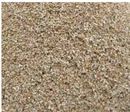
Minichip-Fraktion zur Pelletierung im 100.000 t/J-Werk von Balcas, einstufig aus Stammholz erzeugt mit RE-TH 650
