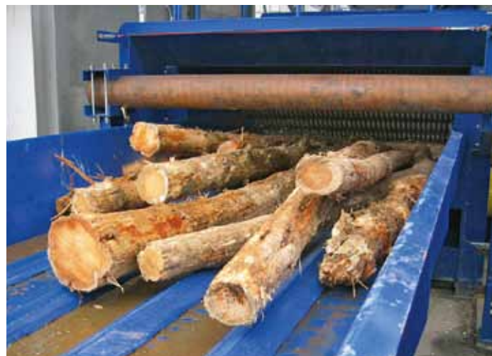
Einzug der Rundhölzer zur einstufigen Zerkleinerung mit RE-TH 650x2000/9
