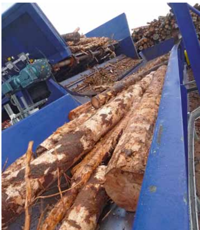
Online-Übergabe von der Entrindung zur Hackstation
